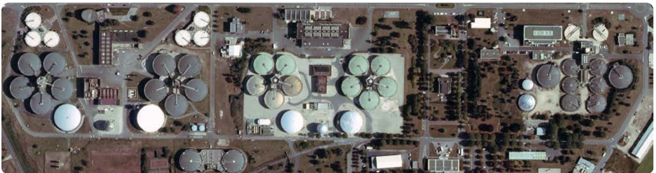
PRODUCTION DE BIOGAZ : GRAPPES DE DIGESTEURS ET GAZOMÈTRES DE L'USINE SEINE AVAL
