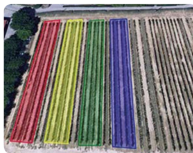
VUE AÉRIENNE D'UNE PARCELLE DE VIGNE IRRIGUÉE PAR L'EAU DU RÉSEAU (en violet), L'EAU BRUTE (en rouge), L'EAU USÉE TRAITÉE DE QUALITÉ B (en vert) ET L'EAU USÉE TRAITÉE DE QUALITÉ C (en jaune)
