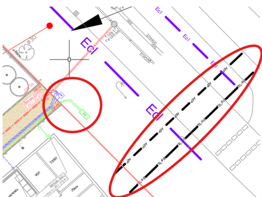
Figure 9 – Illustration d'un problème de décalage des raccordements de réseaux projetés (Source : Réalisation personnelle – Projet INGEROP)
