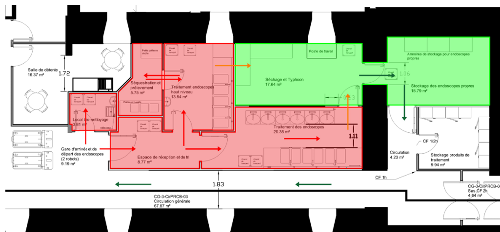
Figure 16. Schéma de la marche en avant dans l'unité de traitement des endoscopes
