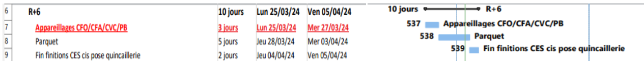
Figure 4 : Extrait du planning d'un niveau de logements sociaux au stade de finitions, réalisé avec MS Project
