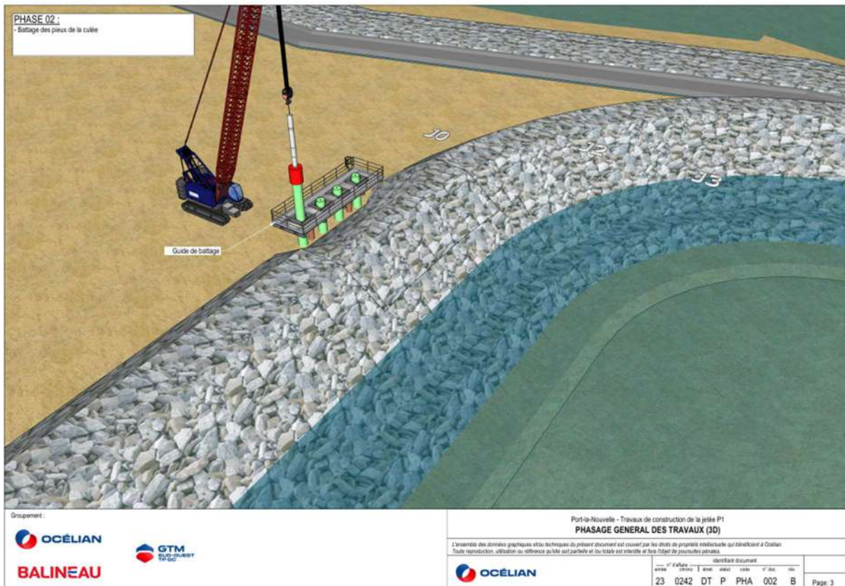
Figure 23 Phasage 3D 4 premiers pieux à terre
