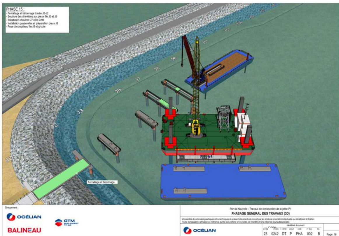
Figure 26 Phasage 3D complexité des mouvements entre chaque ponton
