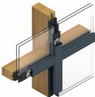
*Figure 7 : Modélisation de la structure des menuiseries extérieures mixtes bois-acier de la crèche Saint-Roch*
