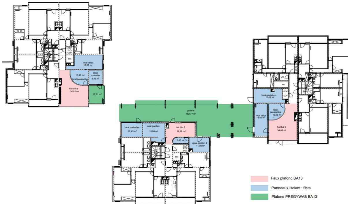
Figure 17 - Plan de localisation des isolants et faux plafonds. Source : auteur (2023)
