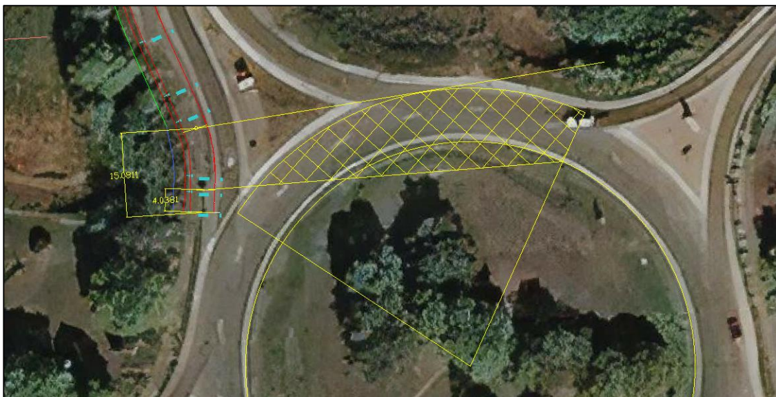
Figure 19 : Visibilité pour le franchissement du carrefour giratoire (Source : [1])
