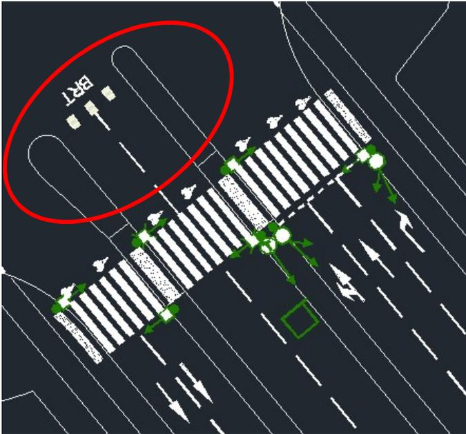
Figure 16 : détails du plan du carrefour BRT090 avant préconisations de réaménagement
