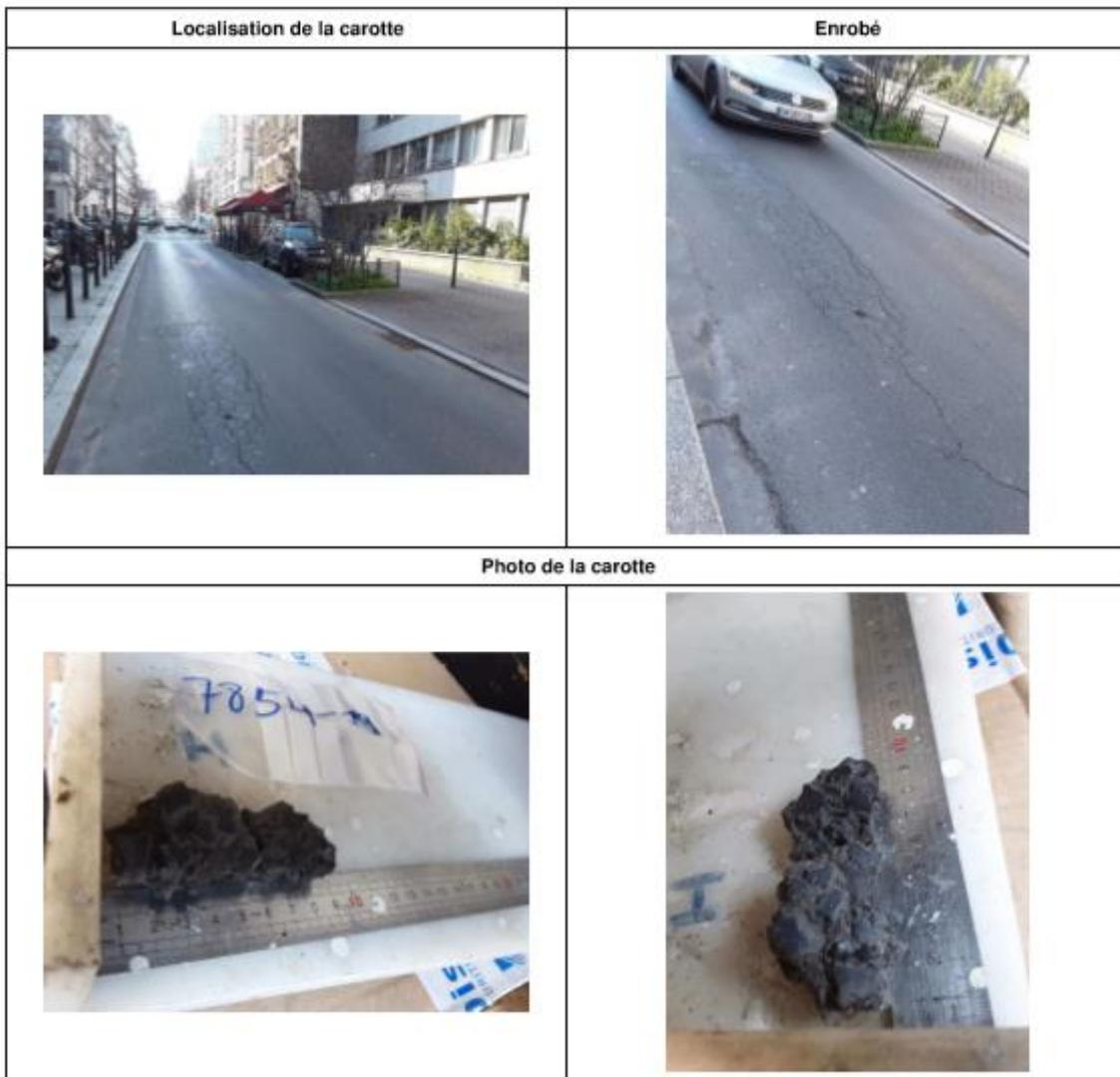
Figure 2 : Analyse d'amiante et de HAP
