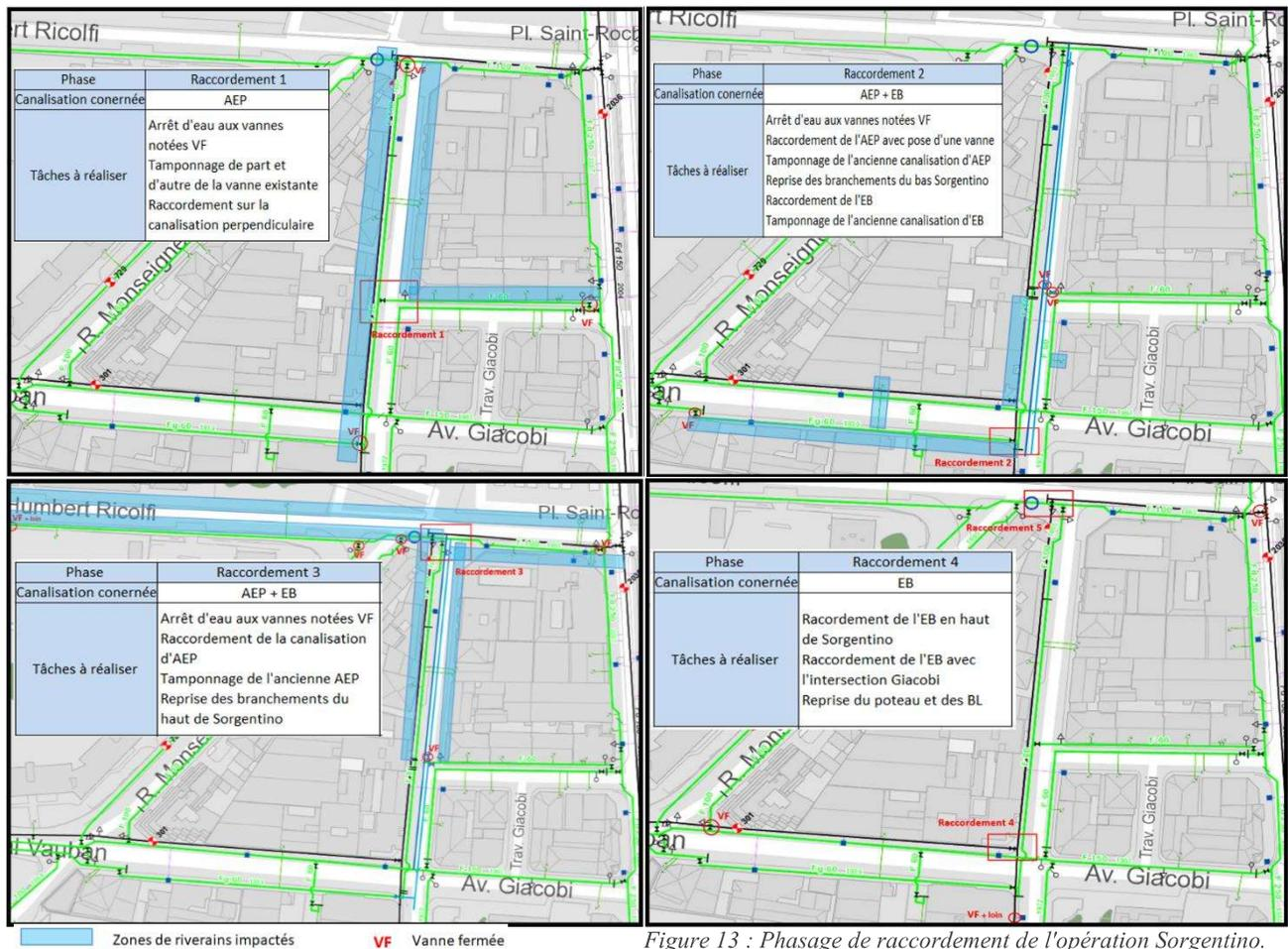
Figure 13 : Phasage de raccordement de l'opération Sorgentino.
