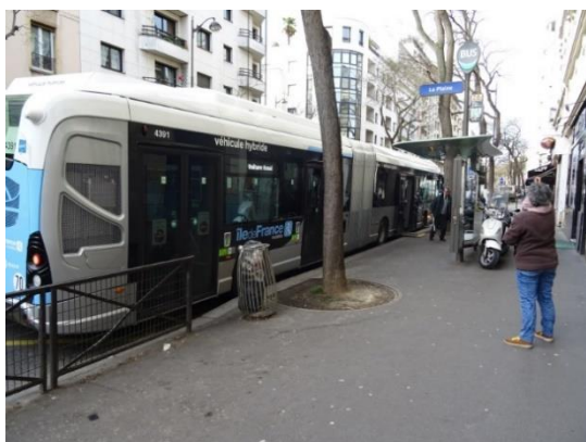
Photo 7 - Encombrement de la porte 3 (Jacques BAVAY)
