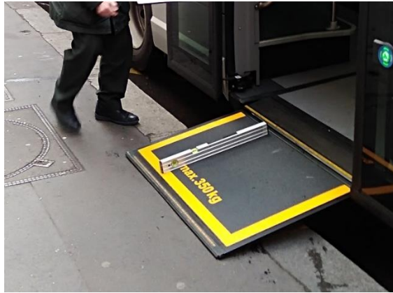
Photo 2 - Mesure de la pente d'une rampe UFR, Square Caulaincourt (L80) (Jacques BAVAY)
