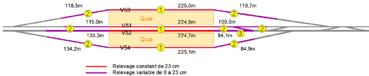
Figure 10: Schéma de relevage des voies – Gare Magenta (5)
