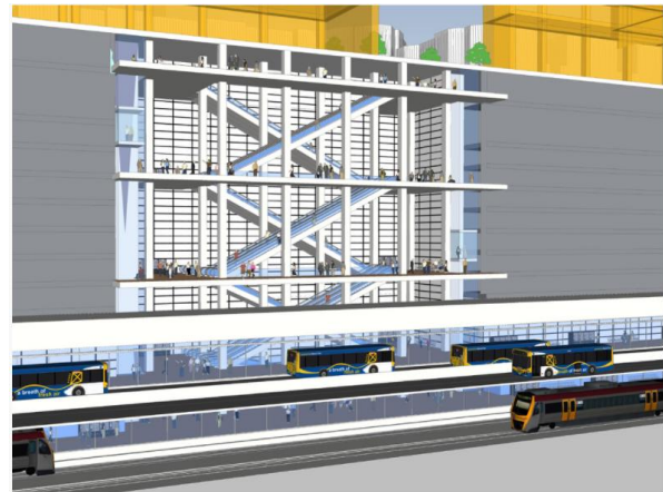
Figure 34 : Coupe longitudinale de la nouvelle station bus/métro
