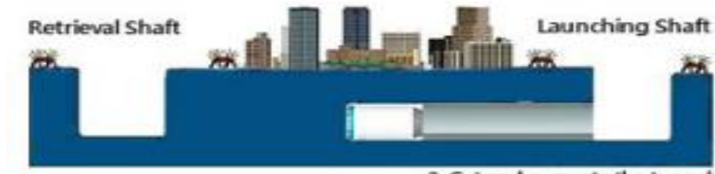
Figure 28 : Construction des puits d'accès pour le tunnelier
