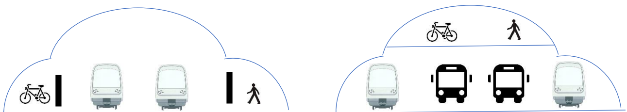
Figure 36 : Propositions d'aménagement des espaces du tunnel
