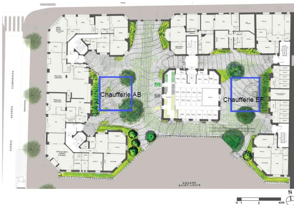
Figure 12: Implantation des chaufferies sur le plan futur
